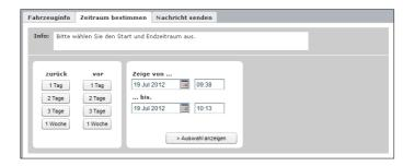
Datum und Uhrzeit werden jeweils entsprechend den gewählten Buttons angepasst. Mit [> Auswahl anzeigen] verschiebt sich die Zeitachse und Datendarstellung entsprechend.
